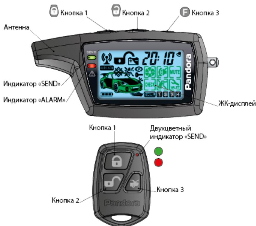
**Индикатор "Send" (зеленого цвета): Вспыхивает** - подтверждение наличия связи в канале оповещения (при выключенном зажигании) **Индикатор "Alarm" (Красного цвета)**
