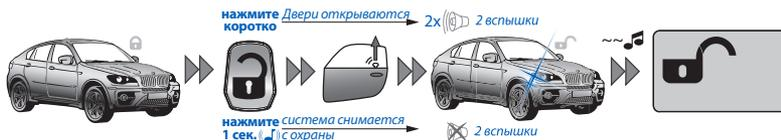
Для снятия системы с охраны коротко нажмите на кнопку брелока, при этом Вы услышите два коротких звуковых сигнала и увидите две вспышки указателей поворотов, брелок проигранет мелодию «снятие с охраны», пиктограмма состояния системы охраны примет вид:
