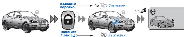
Для того чтобы облегчить поиск своего автомобиля на крупной автостоянке, коротко нажмите на кнопку во время, когда автомобиль находится под охраной, система выдает 5-кратный звуковой сигнал сирены и пять вспышек указателей поворота.
