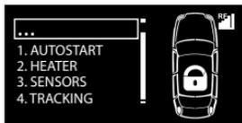
1. **AUTOSTART** - настройка параметров автоматического запуска двигателя
