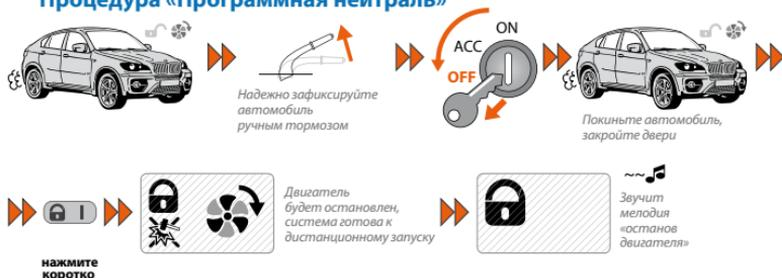
В случае если предполагается использовать дистанционный или автоматический запуск двигателя на автомобиле с МКПП, то перед постановкой автомобиля на охрану необходимо выполнить следующую последовательность действий:
