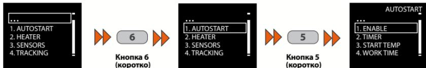
1. **ENABLE** - включение/выключение автоматического запуска
