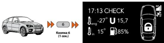
Для получения информации о температуре двигателя, салона, напряжения аккумулятора и уровня топлива (зависит от автомобиля) необходимо нажать и удерживать в течение 1 сек. кн. 6. Для выхода из режима коротко нажмите кнопку F или выход произойдет автоматически через 10 сек.
