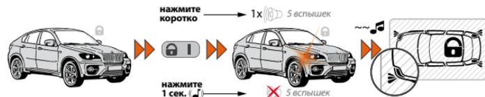
Для того чтобы облегчить поиск своего автомобиля на крупной автостоянке, коротко нажмите на кнопку **🔒 I** во время, когда автомобиль находится под охраной, система выдаст 5-кратный звуковой сигнал сирены и пять вспышек указателей поворота.
