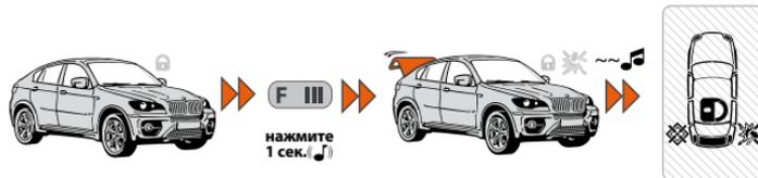
Если система находится под охраной, то одновременно с открытием замка багажника из контура охраны исключается зона багажника и отключаются шок-сенсор и доп. датчик, все остальные зоны остаются под охраной.
