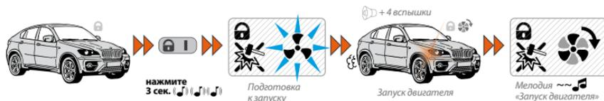
**1 2 3 \*** - Дистанционный запуск двигателя при помощи мобильного телефона
