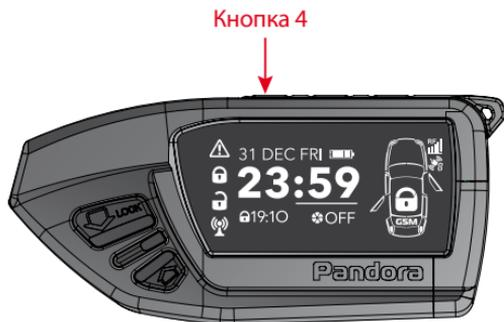
В случае, если Вам что-то угрожает - нажмите кнопку 4 на 1 сек. и на все номера телефонов, запрограммированные в системе для экстренных оповещений, Pandora DXL 3970 в автоматическом режиме совершит голосовые вызовы и разошлет SMS - сообщения с координатами автомобиля (необходим GPS/ГЛОНАСС приемник).
