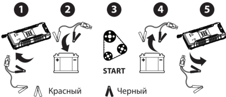
1. Убедитесь, что заряд пуско-зарядного устройства ПускАч достаточен для запуска вашего двигателя. Рекомендуется иметь уровень заряда более двух светодиодов – 50% и выше (для мощных двигателей уровень заряда должен быть полным). Подключите комплектные кабели типа «крокодил» к 12В пусковому разъему.
