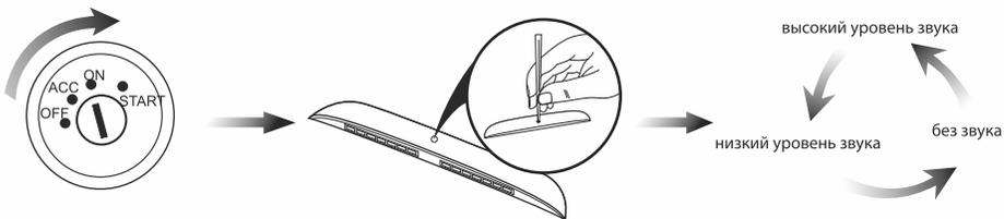
Включите зажигание. Нажмите кнопку регулирования громкости звука, чтобы выбрать наиболее подходящий уровень звука, либо выключить звук.
