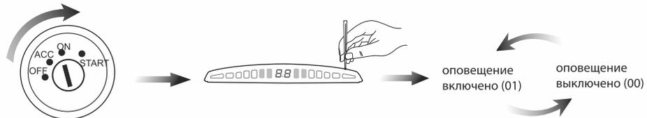
Включите зажигание. Чтобы вкл/выкл звуковое/голосовое оповещение, нажмите и удерживайте кнопку позади индикатора в течении 2 сек., затем нажмите ее еще один раз.
