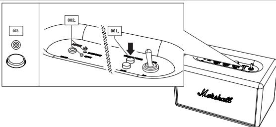
001. НАЖМИТЕ КНОПКУ ИСТОЧНИК/АКТИВАЦИЯ ДЛЯ ВЫБОРА ИСТОЧНИКА ИЛИ ПЕРЕКЛЮЧЕНИЯ МЕЖДУ ПОДКЛЮЧЕННЫМИ ИСТОЧНИКАМИ.
