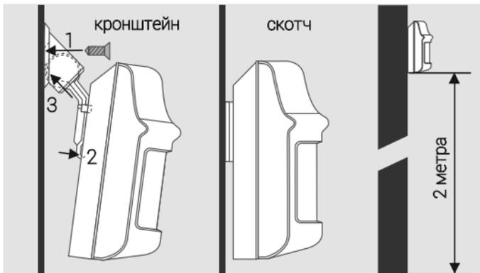
Не устанавливайте сигнализатор рядом с кондиционером, радиатором отопления, камином, печью и т.п.
