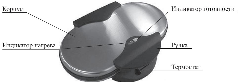
Индикатор нагрева загорается при включении вафельницы. Когда рабочие поверхности достигнут установленной термостатом температуры, индикатор нагрева погаснет, и загорится индикатор готовности. Когда поверхности остынут, индикатор готовности погаснет и загорится индикатор нагрева, пока рабочие поверхности не прогреются вновь.
