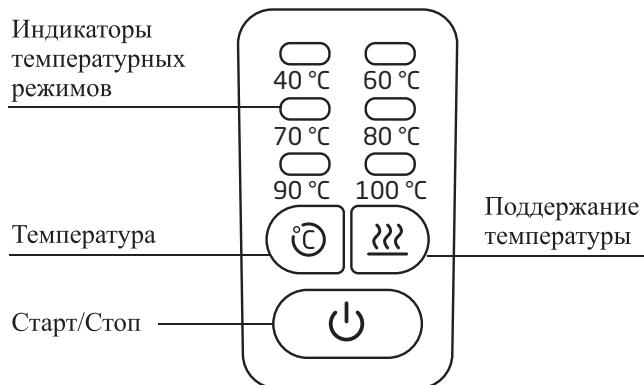
Кнопка «Старт/Стоп» служит для включения и выключения чайника. При включении температура устанавливается на 100 °C. При выключении чайника все установки сбрасываются.
