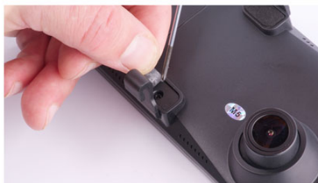
ОТВИНЧИВАЕМ ВИНТЫ ПОД НАКЛАДКАМИ
