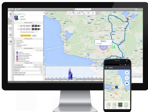
iON ULC работает в комплексе с программной мониторинговой системой My iRZ Online, которая позволяет просматривать маршруты передвижения по данным от устройства, а также в реальном времени отслеживать местоположение объекта, строить маршрутные отчёты и настраивать различные SMS/e-mail-уведомления.
