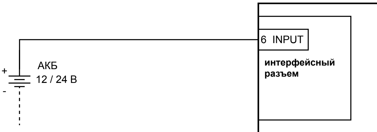
Рис. 3.6. Схема подключения тревожной кнопки (HW1.0)
