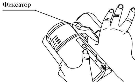
3. Отсоедините АКБ, нажав на кнопку фиксатора. Нажимайте на дальнюю от ручки АКБ часть кнопки.
