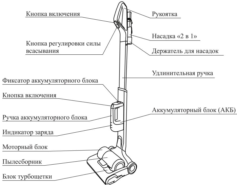
Моторный блок с присоединенным пылесборником образуют моторный блок с пылесборником (МБП).
