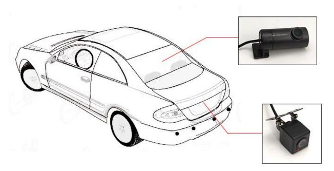
2. Подключите камеру заднего вида к видеорегистратору. Камера подключается в порт для подключения камеры заднего вида (см. Руководство пользователя HYBRID UNO SPORT).
