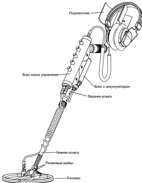
Закрепляя поисковую катушку, установите резиновые уплотнители. Крепление затягивается вручную.
