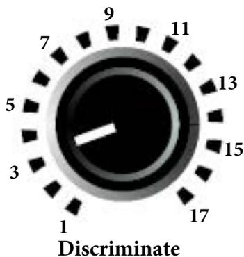
Эта настройка используется совместно с «Disc». Шкала позволяет определить, какие цели считать «нежелательными». Если Ручка повернута так, чтобы ее риска совпадала с цифрой «1» Excalibur будет игнорировать железные цели. Большие железные цели могут производить короткие сигналы или "щелкать", однако, цветные цели дадут хороший сигнал.
