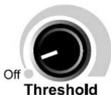
Эта настройка позволяет Вам регулировать уровень порогового тона, а так же включать и выключать Ваш металлодетектор. Когда ручка повернута против часовой стрелки до щелчка, Excalibur находится в состоянии "Выключено" (off). Если ручку повернуть до щелчка по часовой стрелке - Excalibur включится. Фон или
