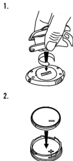
1. Откройте крышку батарейного отсека, повернув ее против часовой стрелки с помощью вилки датчика или монеты в сторону надписи OPEN (см. рис. 1).
