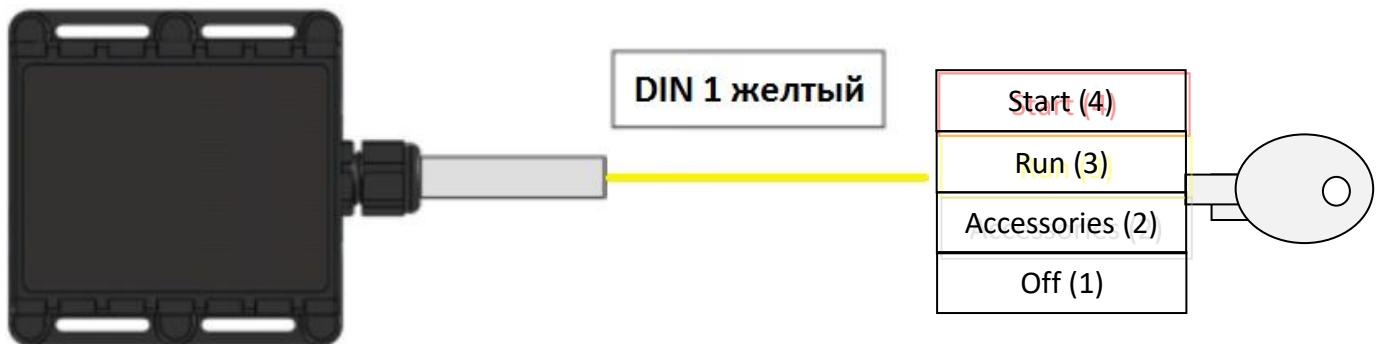
Кроме того, можно контролировать сигнал «Зажигание», найдя любой источник положительного сигнала, который работает только при включенном зажигании, например, источник питания автомагнитолы.
