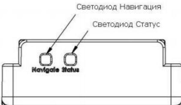
Статус приема сигналов определяется по характеру их свечения:
