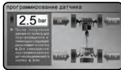
После получения данных нажмите кнопку дистанционного управления для их запоминания. Стрелка станет зеленой. Программирование датчика завершено.
