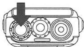
Для включения радиостанции следует повернуть Регулятор громкости по часовой стрелке. При включении радиостанция издаст звуковой сигнал.
