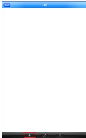
Введите произвольное имя устройства, IP адрес, порт мобильного мониторинга (по умолчанию – **34599**), имя пользователя и пароль, установленные на регистраторе или IP камере и максимальное количество каналов устройства.
