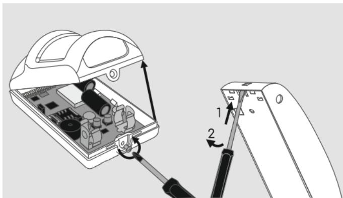
Включите датчики. Нажмите на рычаг тампера и, удерживая его, удалите защитную пластину возле батареи питания. Дождитесь свечения индикатора датчика. Отпустите тампер. Поочерёдно включите все датчики.
