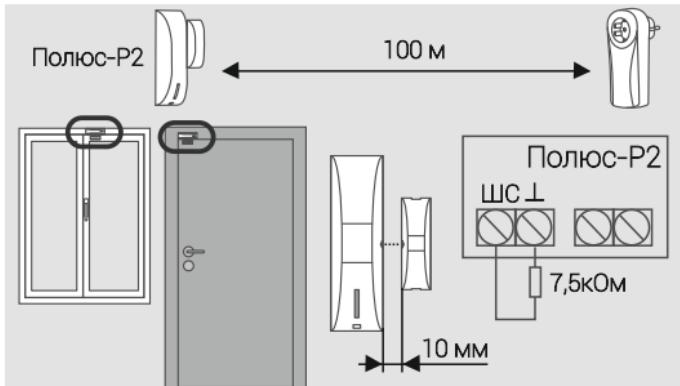
Подключение дополнительных проводных магнитоконтактных датчиков к «Полюс-Р2»
