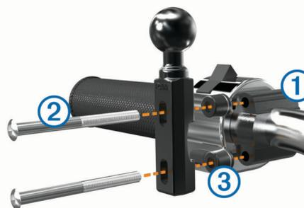
**ПРИМЕЧАНИЕ.** в комплект входят стандартные болты 1/4 дюйма и болты М6. Подберите болты размера заводских болтов на кронштейне зажима сцепления или тормоза.
