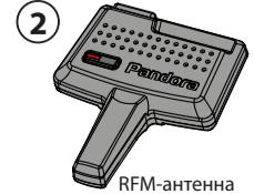
Рекомендуется располагать RF-модуль на лобовом стекле. При этом обеспечить расстояние от металлических частей кузова до RFM-антенн не менее 7 см. Учитите, что наличие встроенного обогрева лобового стекла может снизить дальность работы радиоканала.
