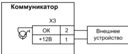
Рис.16 Схема подключения внешнего устройства к коммуникатору
