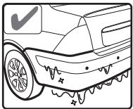
очищайте датчики от льда с помощью горячей воды, продуйте датчики сжатым воздухом, для удаления влаги
