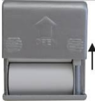
Рисунок 7 – Снятие крышки с приборного блока
