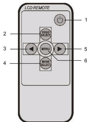
1. Включение/Выключение монитора
