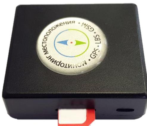
Установите SIM-карту в слот срезанным углом наружу, как показано на рисунке. После щелчка SIM-карта зафиксируется в слоте.
