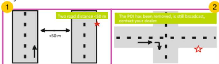
① При расстоянии между двумя параллельными дорогами менее 50м возможно ложное сообщение о GPS точке.
