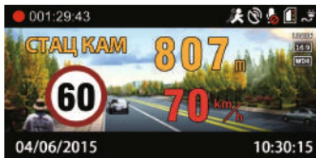
Превышение скорости в промежуточном отрезке дороги: после входа в промежуточный отрезок дороги прибор начинает считать среднюю скорость, если средняя скорость больше ограниченной скорости, средняя скорость на экране
