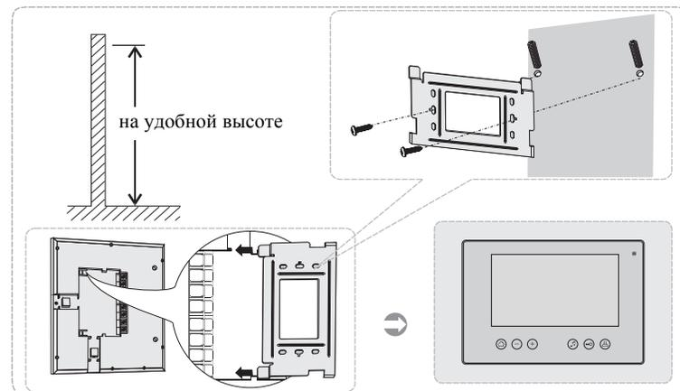
1. После определения места установки монитора, надежно прикрепите кронштейн к стене.
