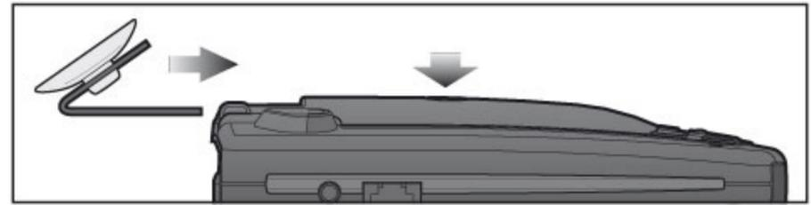
Снять детектор Вы можете нажав на кнопку разблокировки фиксатора кронштейна и потянув детектор на себя. Убедитесь, что оставленный на лобовом стекле кронштейн не представляет опасности.
