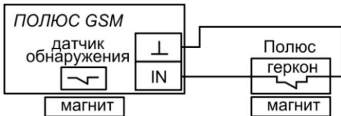
**Рис.6в** Схема подключения внешних датчиков.
