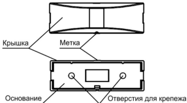
**Рис.3 Конструкция магнита**
