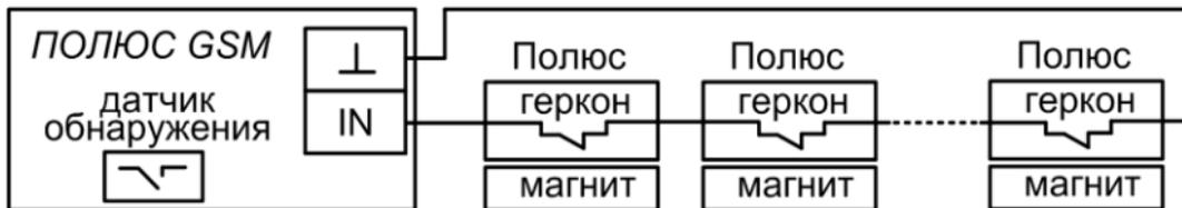
**Рис.6б** Схема подключения внешних датчиков.
