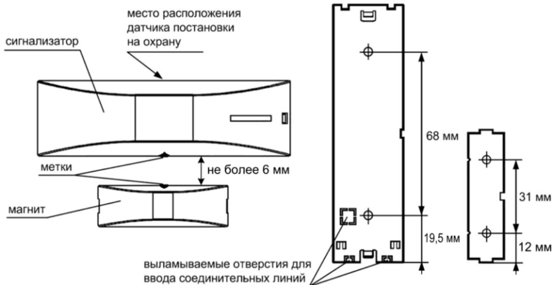
Рис.9 Схема установки, установочные и присоединительные размеры
