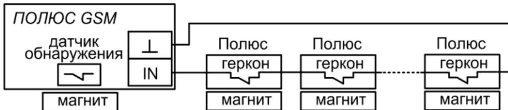
**Рис.6а** Схема подключения внешних датчиков. Значение «2» параметра №37
