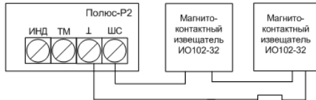
Рисунок 3.7 – Подключение внешних извещателей
