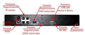
подключения IP камер, разъем RJ45 (WAN) для подключения к локальной сети (Интернет), разъем RS-485 для подключения пульта управления поворотными камерами (не используется).
