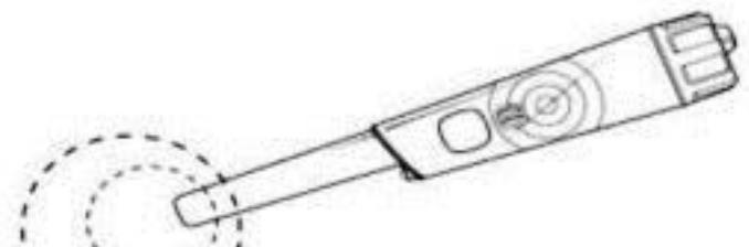
Область определения пинпойнтера Bullseye TRX концентрируется вокруг наконечника, что облегчает сосредоточение на цели
